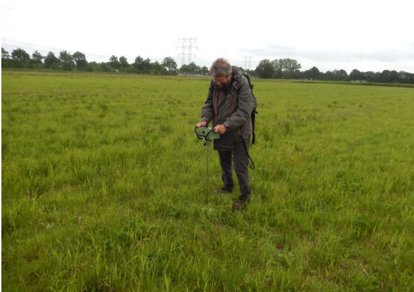
Foto 4 met de penetrometer wordt de compactie van de bodem gemeten
