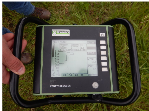
Foto 5 grote uitslag van compactie in de bovenlaag geeft een grote dichtheid weer
