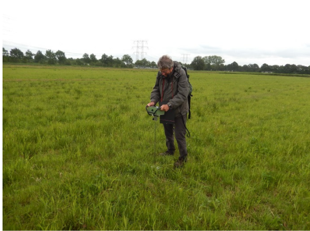
Foto 5 met de penetrometer wordt de compactie gemeten
