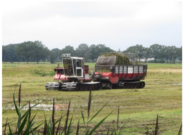
Foto 10 Met een ander rupsvoertuig en aanhanger wordt het maaisel afgevoerd
